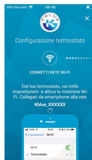
Una volta connessi alla rete direct si dovrà inserire il nome della rete WiFi e la password alla quale verrà connesso il termostato. Inoltre è necessario configurare l'accesso tramite DHCP oppure inserendo un IP statico.
