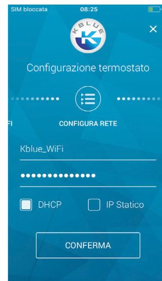
Confermata la configurazione di rete verrà visualizzata la schermata a lato dove sarà possibile modificare i campi: nome termostato, unità di misura e fuso orario.
